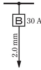
定格電流 30 A のコンセント 2個</p> <p>ハ.
